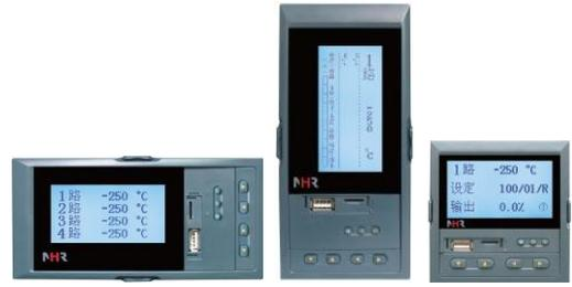
四路独立PID调节，可根据生产控制要求切换选择单点控制与程序段控制两种方式。适用于需要进行高精度测量的控制系统，可对温度、压力、流量、液位、速度等测量信号进行控制。
